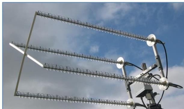
Figure 1 Système d'antennes 4 fois 40 spires C.D. @2,35GHz
