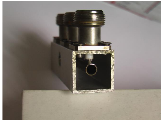
Photo 2 : Le tube soudé à la broche N
