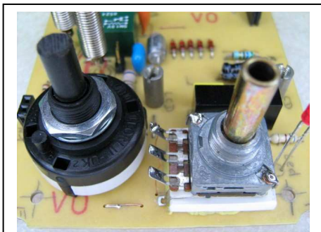
6) Montage particulier du potentiomètre. Avec un modèle à axe long, la plaquette sur élévatrice sera inutile.
