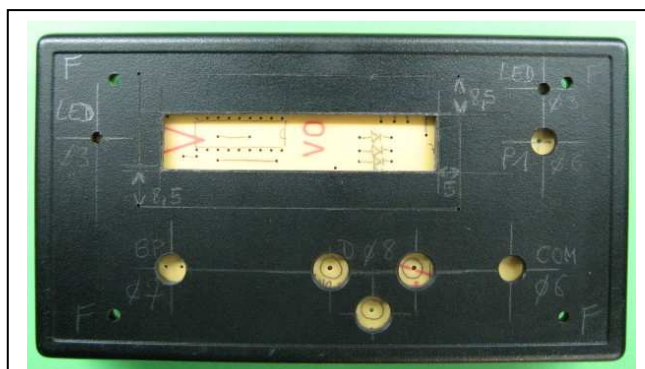
4) Perçages et découpes en face avant. Le pointage des axes a été effectué avec précision à l'étape précédente. Le chainfreinage de la fenêtre d'affichage reste à faire.
