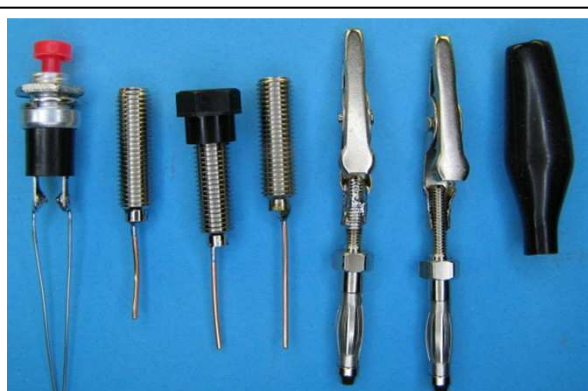
17) Liaisons des douilles, et mini pinces croco à confectionner pour le raccordement simplifié des composants à mesurer (selfs condensateurs varicap).
