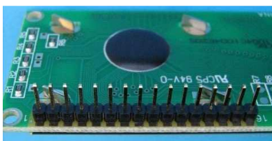
14) L'afficheur LCD sur lequel sera soudé la barrette de 16 picots.
