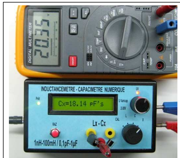
19) Capacité d'une diode varicap BB204 (18,14pF) mesurée avec une tension de polarisation de 20,35V.
