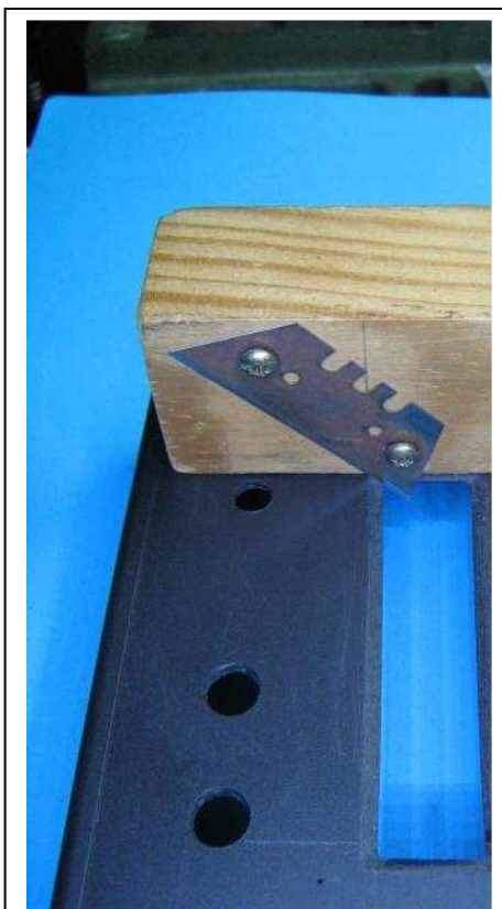
7) Réalisation facilitée des chanfreins avec l'outil de fabrication "maison". La longueur du tasseau de bois devra au moins égaler celle du coffret.
