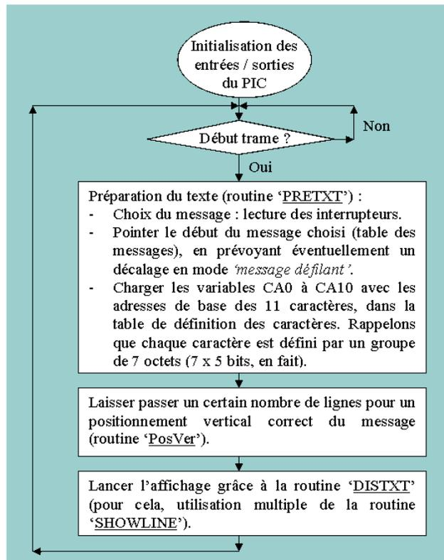
**2-3-2-1)** - Supposons l'horloge active. Le PIC surveille sur son entrée A2 le top de synchro trame ; il va décider d'attendre le début d'une nouvelle trame, et scrute pour cela la fin du top de synchro (front montant sur A2).
