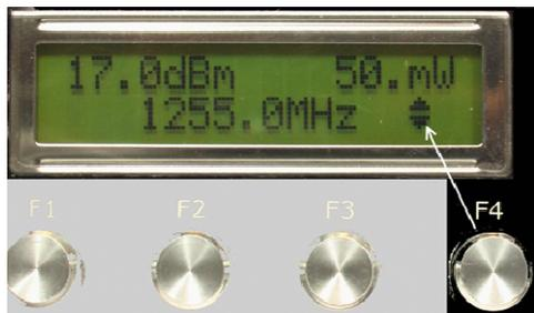
Ligne supérieure : ligne d'information, dans ce cas puissance et ligne inférieure toujours la fréquence en mode utilisation.
