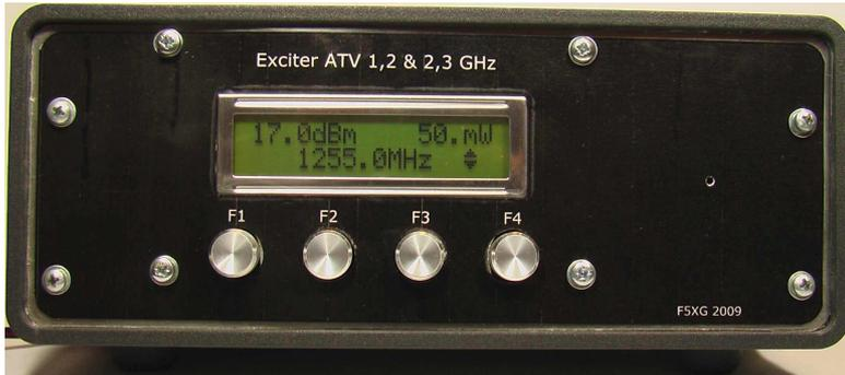
Photo 1 : Face avant de l'ensemble en coffret Schubert n° 218. 200x175x80mm
